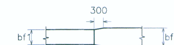
DETALLE 7 TRANSICIÓN DE ANCHO DE ALAS
