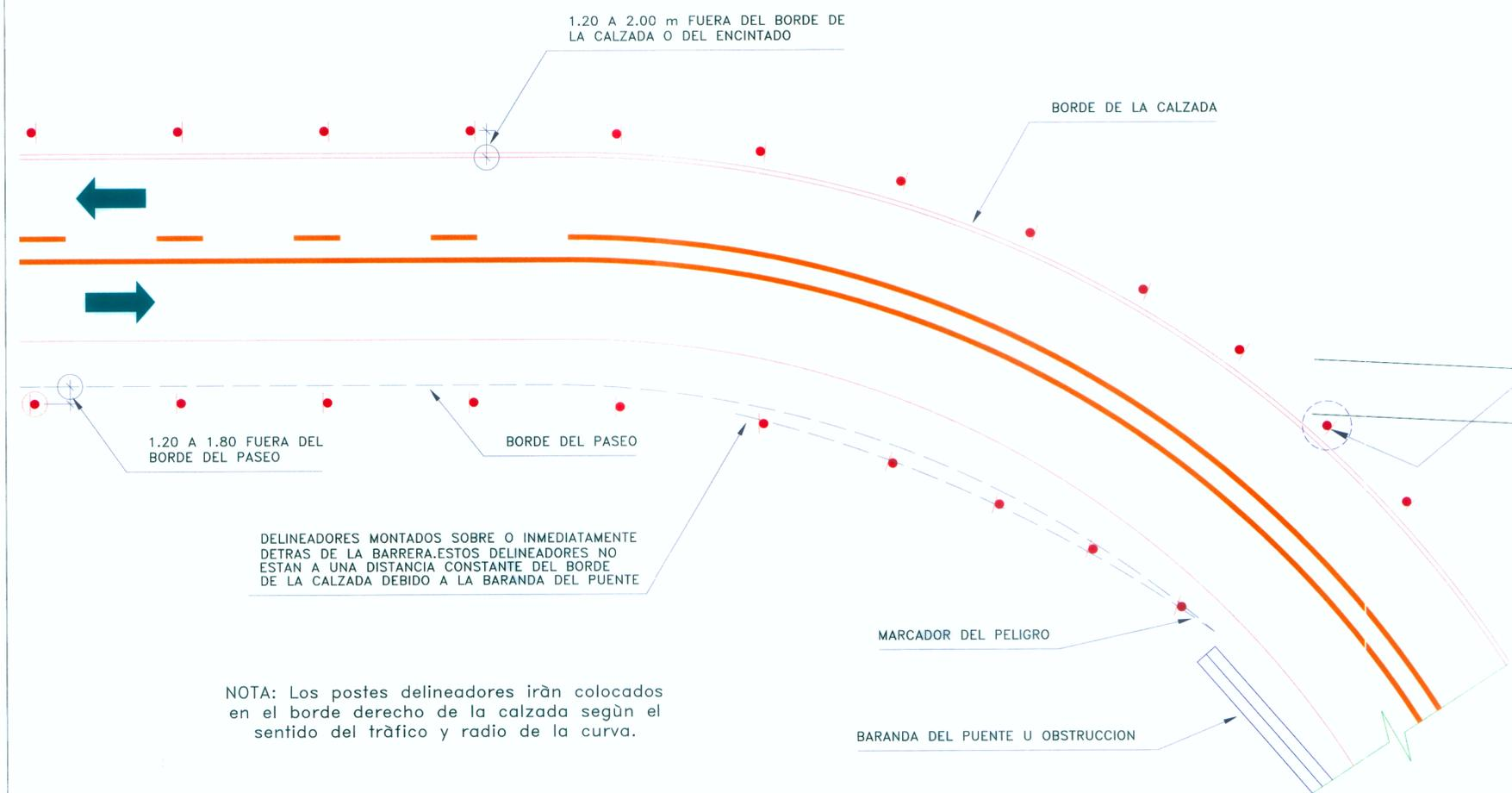
DELINERADORES MONTADOS SOBRE O INMEDIATAMENTE DETRAS DE LA BARRERA. ESTOS DELINERADORES NO ESTAN A UNA DISTANCIA CONSTANTE DEL BORDE DE LA CALZADA DEBIDO A LA BARANDA DEL PUENTE
