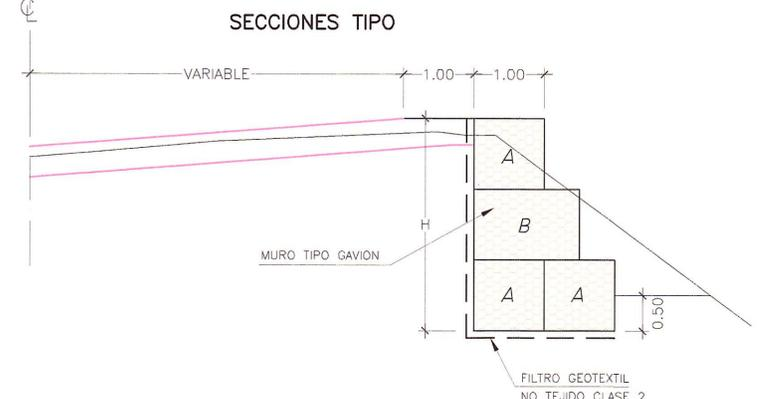
MURO DE CONTENCIÓN PLATAFORMA
