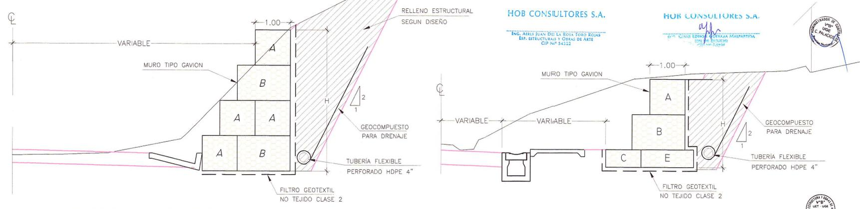
MURO DE CONTENCIÓN DE TALUD SUPERIOR
