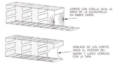
DETALLE CONSTRUCTIVO DE PARAMENTO EN GAVION PARA ALCANTARILLA TMC
