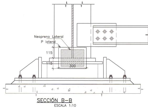
"5" Planchas de Acero de 3mm + 2 de 25mm vulcanizadas con Planchas de Neopreno (18mm interior y 9mm exterior). Dureza 60 Shore A.
