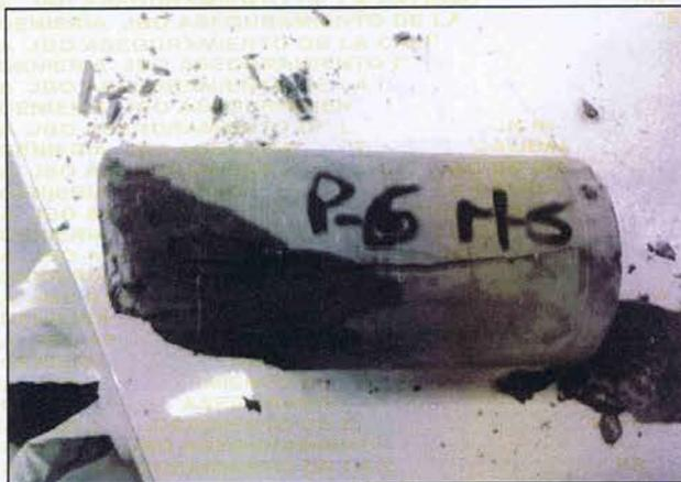
En la imagen podemos observar a la probeta cilíndrica de roca, de la perforación N° 6, Roca Cauce Estribo Der., M-5 después del ensayo a compresión no confinada de especímenes de roca.
