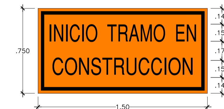
IC-01 INICIO DE TRAMO EN CONSTRUCCION
