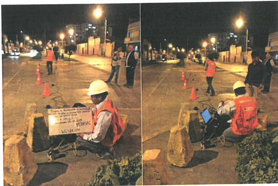
Toma de datos con el equipo Geode Seismic
