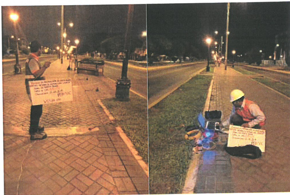
Ejecución del golpe o "shot"(izquierda) y toma de datos con el equipo Geode Seismic (derecha)
