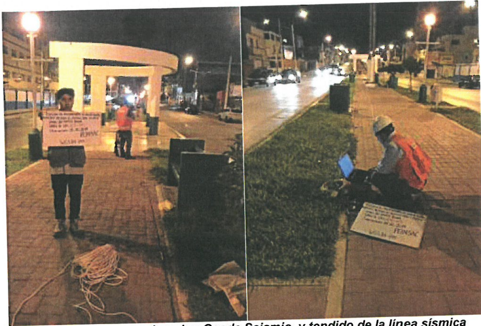
Toma de datos con el equipo Geode Seismic y tendido de la línea sísmica
