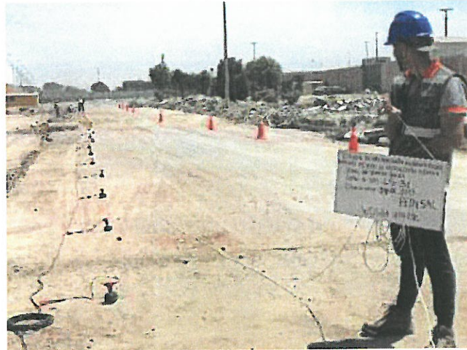
Tendido de la línea sísmica
