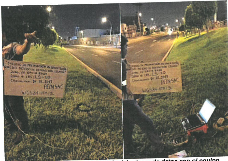
Tendido de la línea sísmica (izquierda) y toma de datos con el equipo Geode Seismic (derecha)
