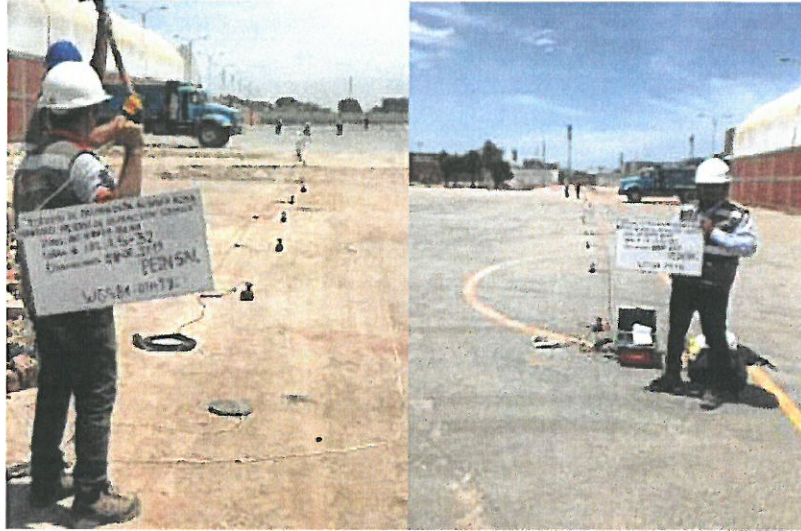
Tendido de la línea sísmica (izquierda) y Toma de datos con el equipo Geode Seismic (derecha)
