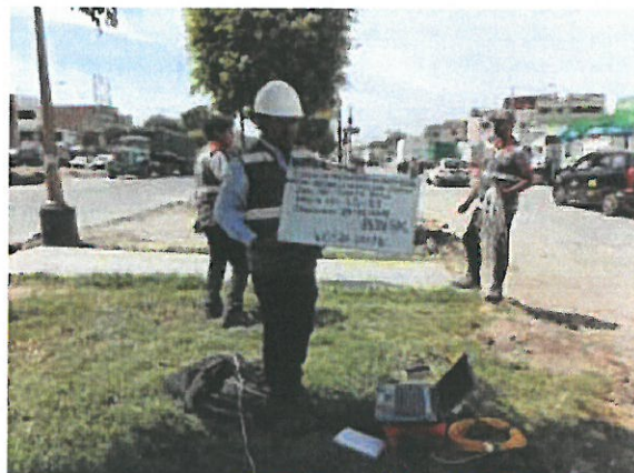
Toma de datos con el equipo Geode Seismic
