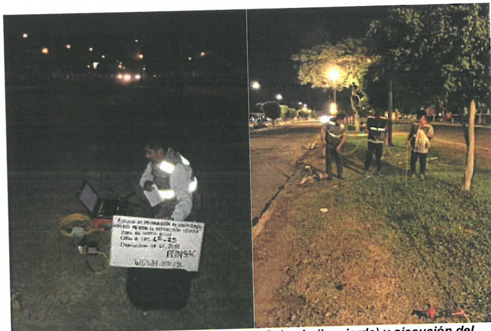
Toma de datos con el equipo Geode Seismic (izquierda) y ejecución del golpe o "shot"(derecha)
