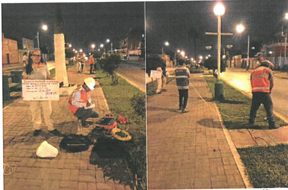
Toma de datos con el equipo Geode Seismic ( izquierda) y preaparción para la ejecución del golpe o "shot" (derecha).
