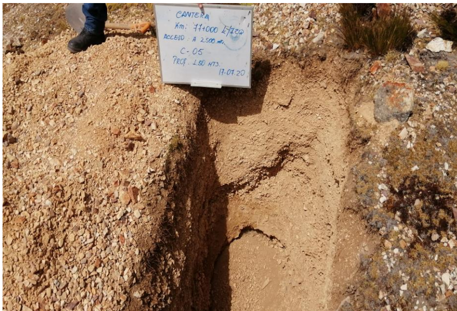
FOTO N°: 06 Muestreo de Material Integral de La Cantera Km.77+000 L/Izq.
