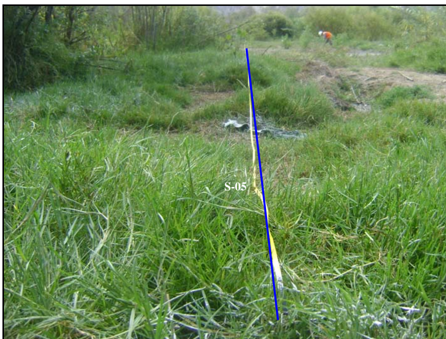
Fotografía 4: Se observa el tendido del cable de refracción sísmica y los geófonos para el Sondaje-04, ubicado en el margen izquierdo del río Quilca.
