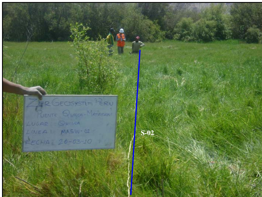
Fotografía 2: Se observa el tendido del Sondaje-02, ubicado en el margen derecho del río Quilca.
