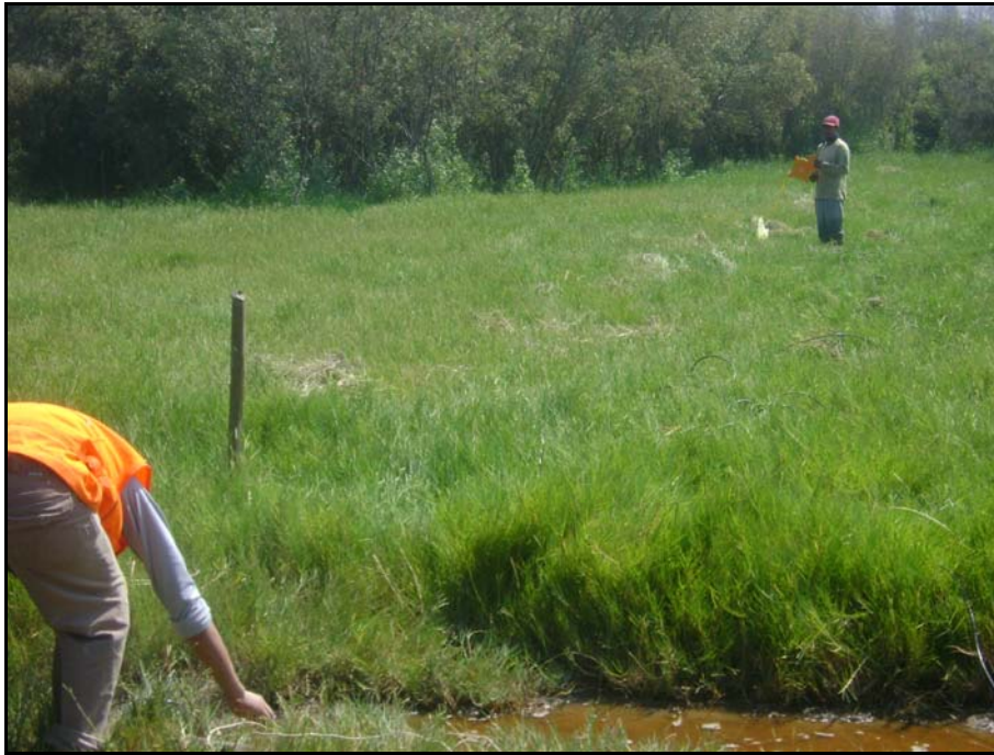
Fotografía 1: Se observa el tendido del cable de refracción sísmica y la colocación de los geófonos, Sondaje-01, ubicado en el margen derecho del río Quilca.
