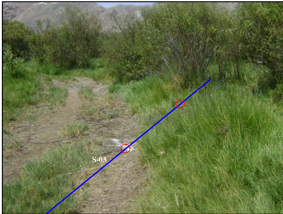
Fotografía 3: Se observa el tendido del cable de refracción sísmica y los geófonos para el Sondaje-03, ubicado en el margen derecho del río Quilca.
