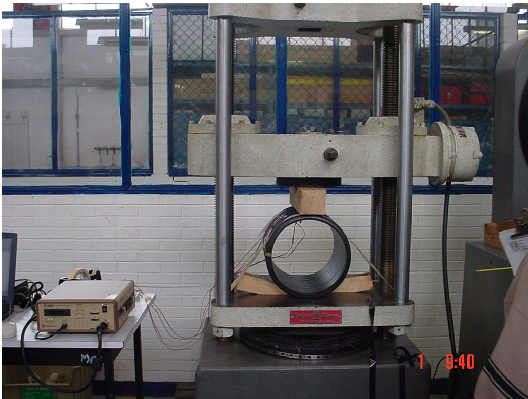
Figura 2.1.1 Arreglo de compresión diametral libre
