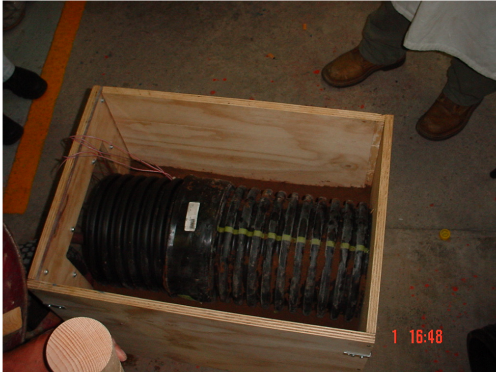
Figura 2.1.5. Dispositivo construido para realizar las pruebas de compresión a tubo confinado
