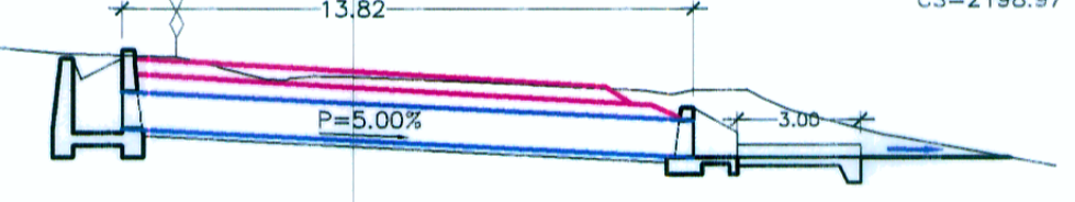
ALCANTARILLA TIPO TMC \phi 36" PROYECTADA 43+890
