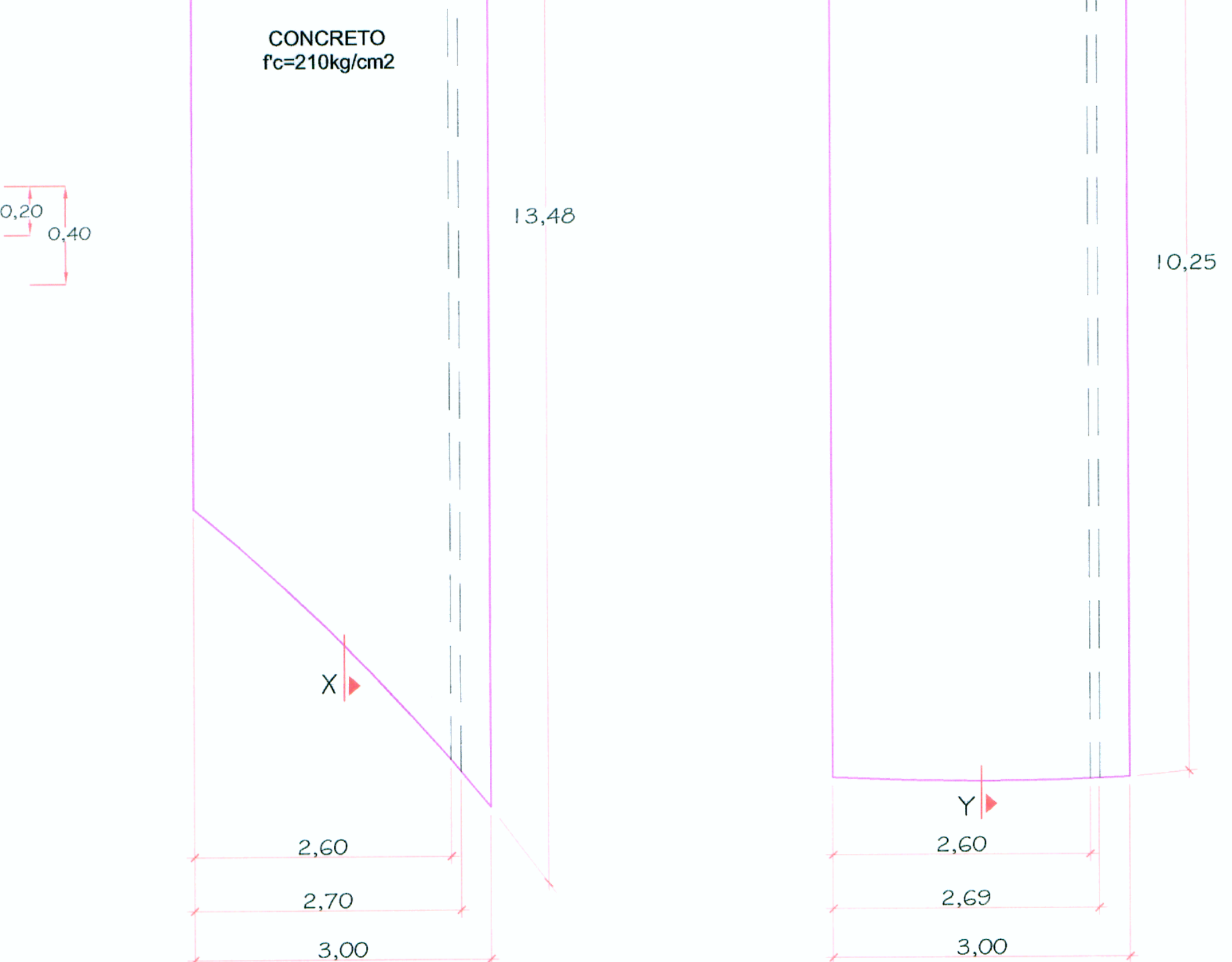
PLANTA LOSA DE APROXIMACION MARGEN IZQUIERDO esc. 1/50 PLANTA LOSA DE APROXIMACION MARGEN DERECHO esc. 1/50
