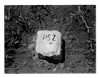
El punto es un hito de concreto con una estaca de Fierro
