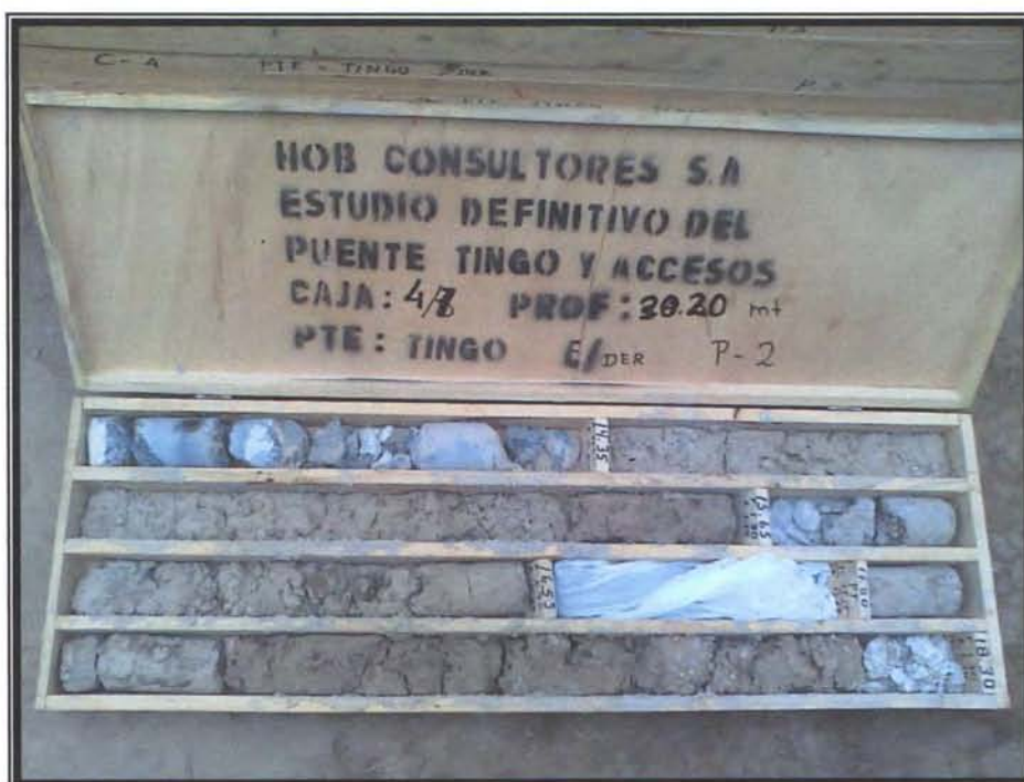
Foto 11: Imagen mostrando la caja N° 4 conteniendo muestras extraídas desde los 13.59 m a 18.30 m de Profundidad
