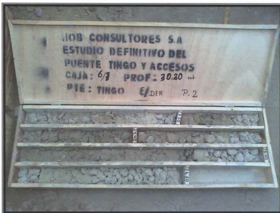
Foto 13: Imagen mostrando la caja N° 6 conteniendo muestras extraídas desde los 22.80 m a 26.60 m de Profundidad
