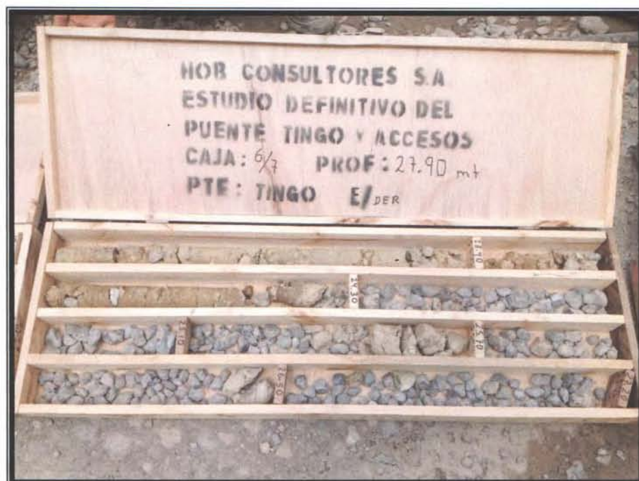
Foto 6: Imagen mostrando la caja N° 6 conteniendo muestras extraídas desde los 22.50 m a 27.20 m de Profundidad
