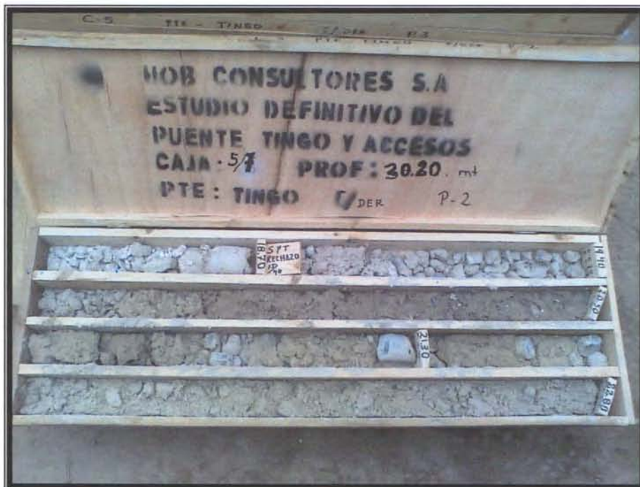
Foto 12: Imagen mostrando la caja N° 5 conteniendo muestras extraídas desde los 18.30 m a 22.80 m de Profundidad
