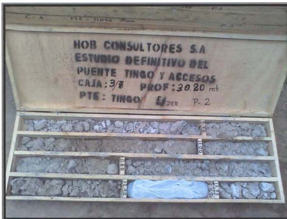
Foto 10: Imagen mostrando la caja N° 3 conteniendo muestras extraídas desde los 9.10 m a 13.59 m de Profundidad
