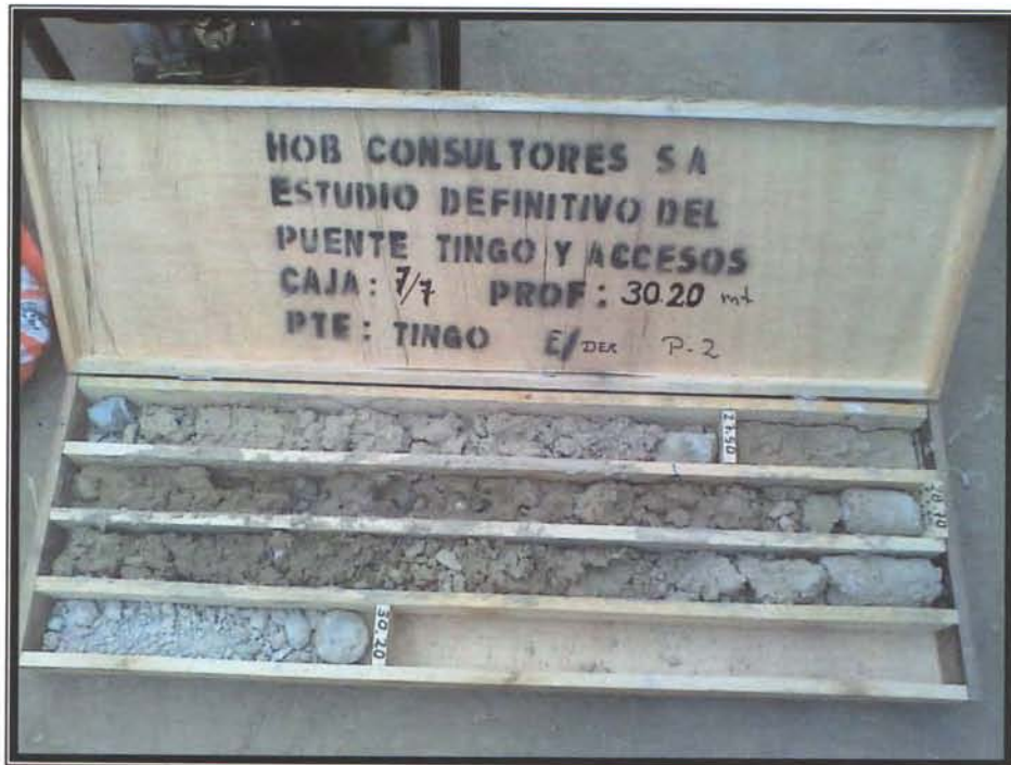
Foto 14: Imagen mostrando la caja N° 7 conteniendo muestras extraídas desde los 26.60 m a 30.20 m de Profundidad
