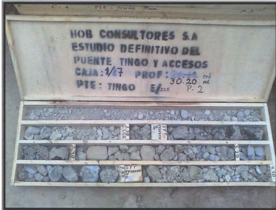
Foto 8: Imagen mostrando la caja N° 1 conteniendo muestras extraídas desde los 0.00 m a 4.50 m de Profundidad
