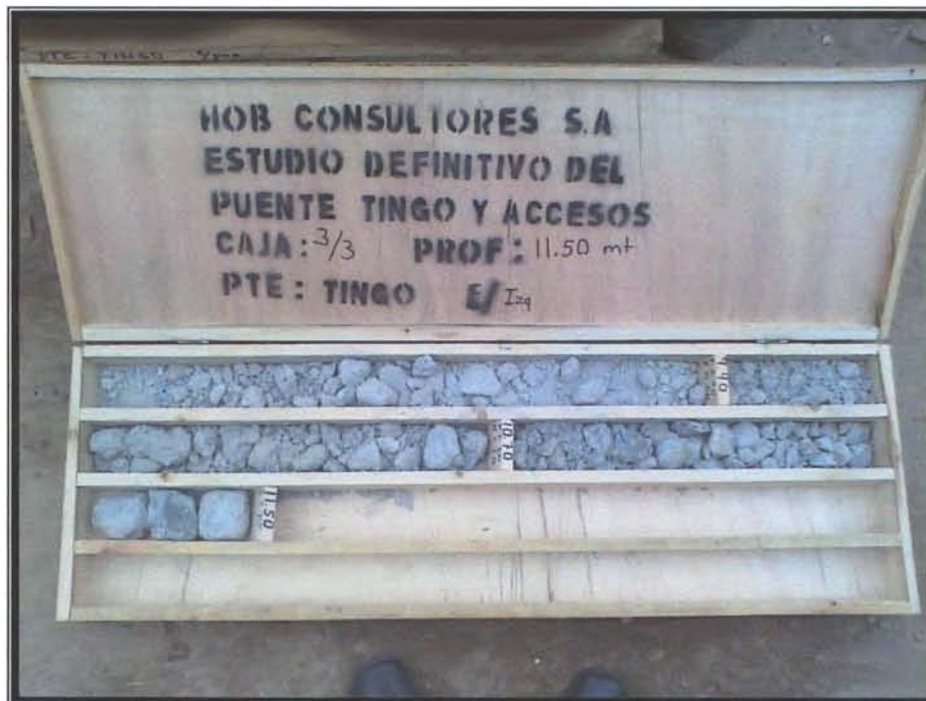
Foto 17: Imagen mostrando la caja N° 3 conteniendo muestras extraídas desde los 9.00 m a 11.50 m de Profundidad
