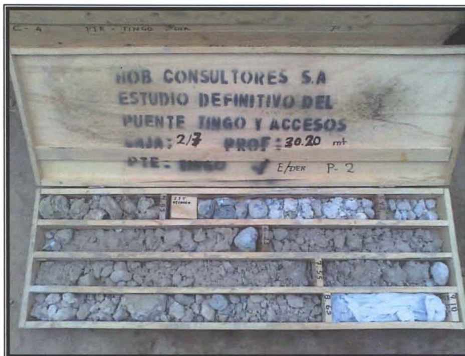
Foto 9: Imagen mostrando la caja N° 2 conteniendo muestras extraídas desde los 4.50 m a 9.10 m de Profundidad
