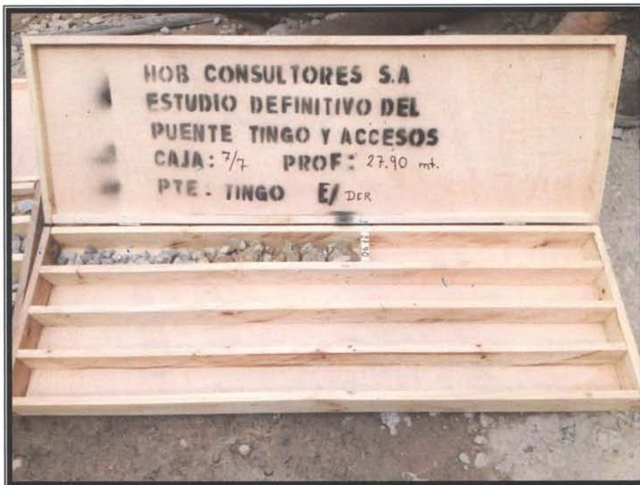
Foto 7: Imagen mostrando la caja N° 7 conteniendo muestras extraídas desde los 27.20 m a 27.90 m de Profundidad
