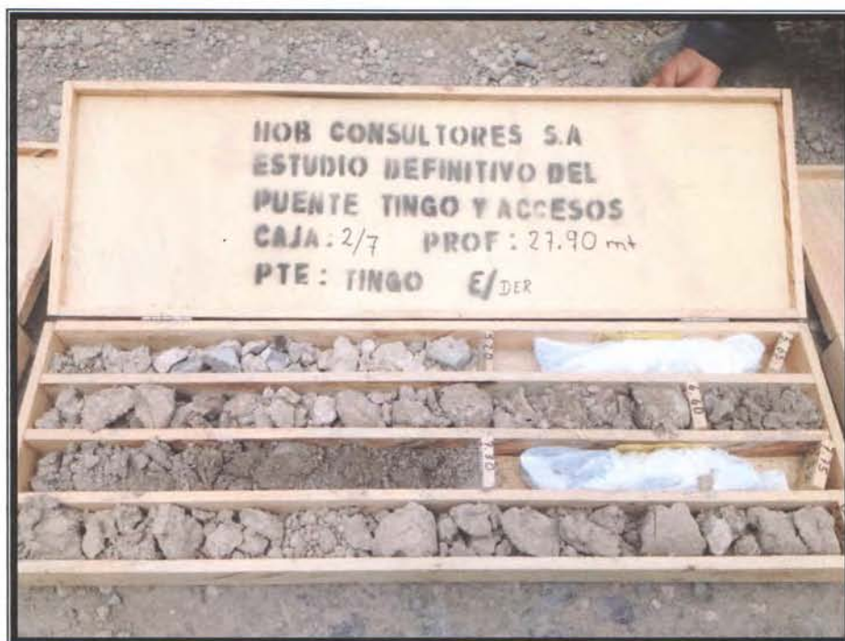
Foto 2: Imagen mostrando la caja N° 2 conteniendo muestras extraídas desde los 4.51 m a 8.95 m de Profundidad
