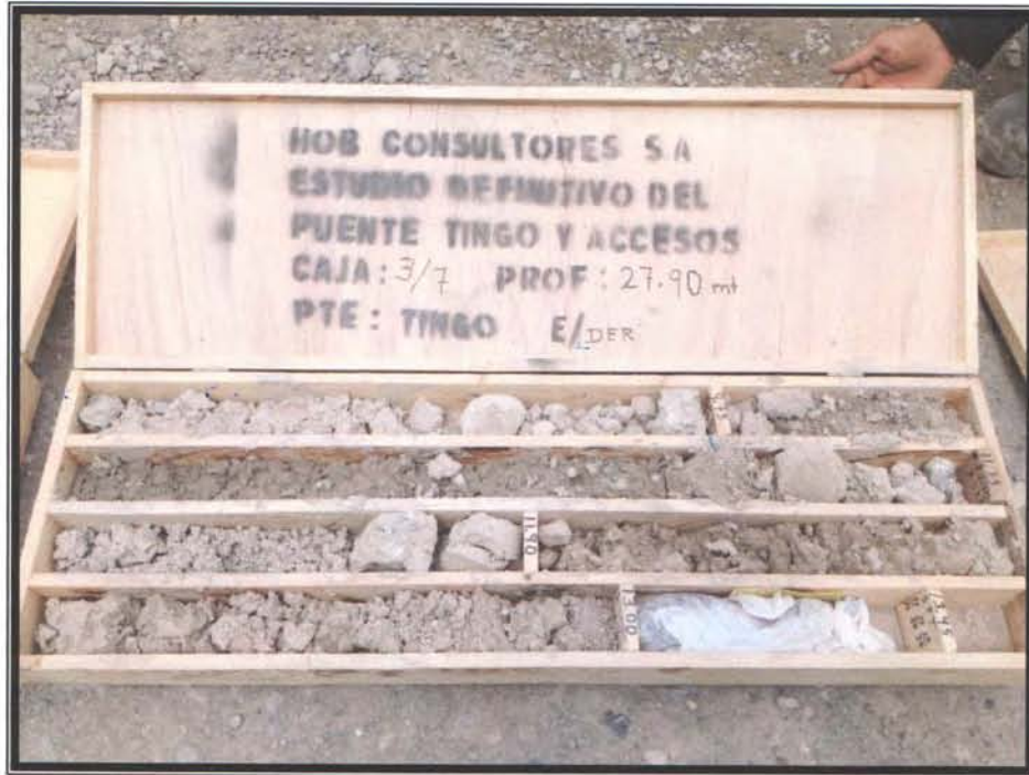
Foto 3: Imagen mostrando la caja N° 3 conteniendo muestras extraídas desde los 8.95 m a 13.45 m de Profundidad
