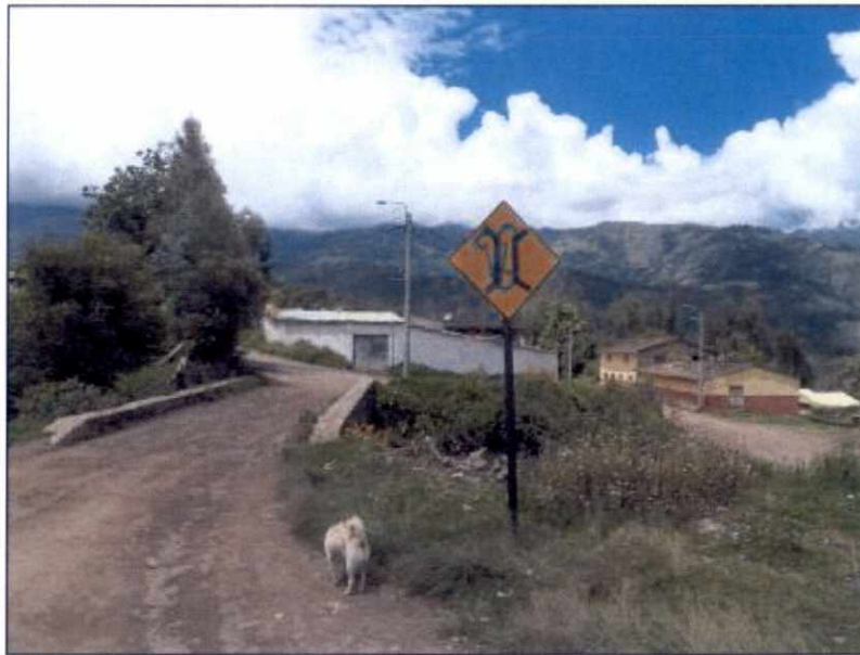
Fig.20: Se pudo observar una señal preventiva inexistente en el Manual de Dispositivos de Control de Tránsito Automotor para Calles y Carreteras ubicada en la progresiva 6+140, en sentido Suroeste – Noreste.
