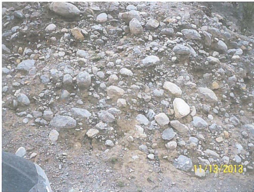
Conglomerado materiales rocosos subredondeados a redondeados
