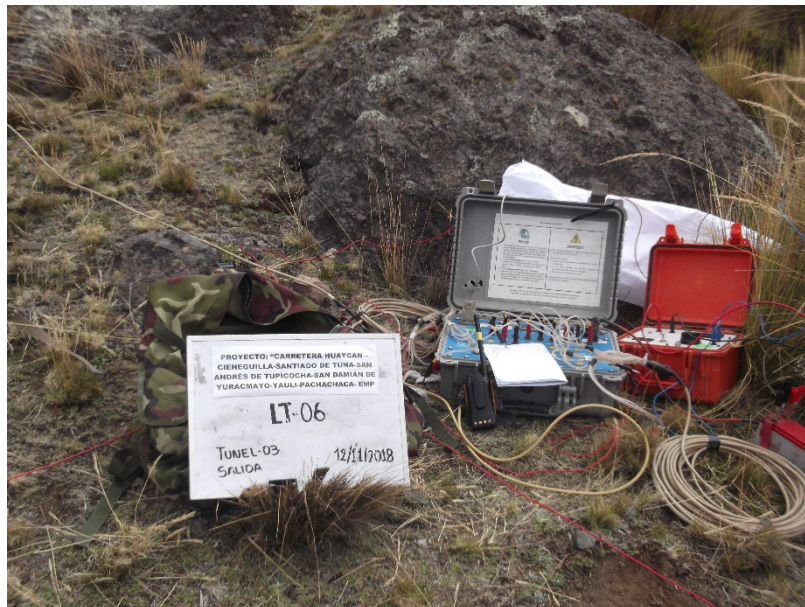
Figura 9: Equipo Eléctrico para tomografía (Receptor y Transmisor Innova Electronics)
